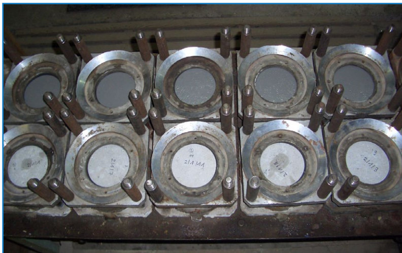
Рис. 1. Установка для испытаний образцов на водонепроницаемость.
