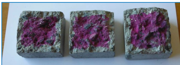
Рис. 13. Внешний вид контрольных бетонных образцов (без покрытия) после 14 суток испытаний
