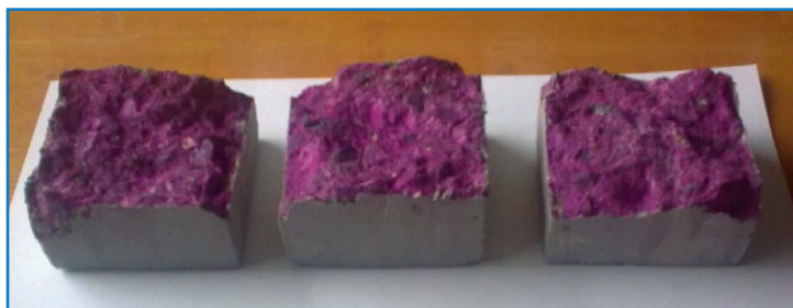
Рис. 12. Внешний вид бетонных образцов с системой покрытия COLORITE BETON после 7 суток испытаний
