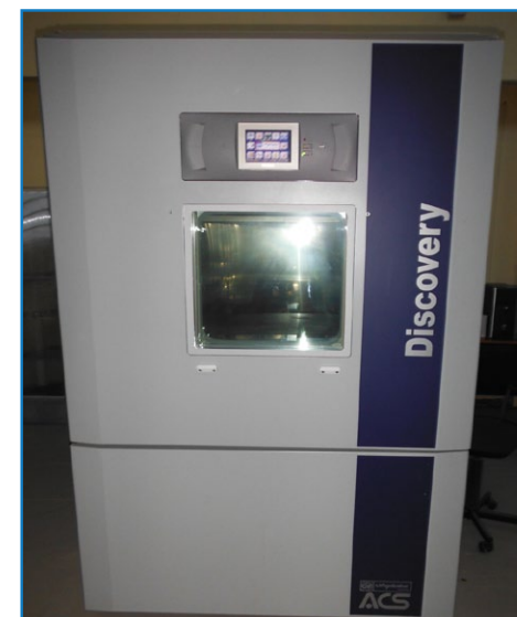
Рис. 3. Климатическая камера DV 1600C для испытаний на морозостойкость.
