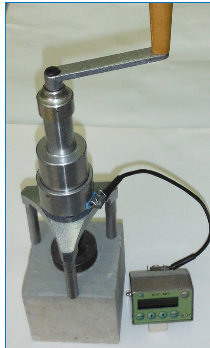
Рис. 9. Измеритель прочности сцепления (адгезии) ПСО-10МГ4.
