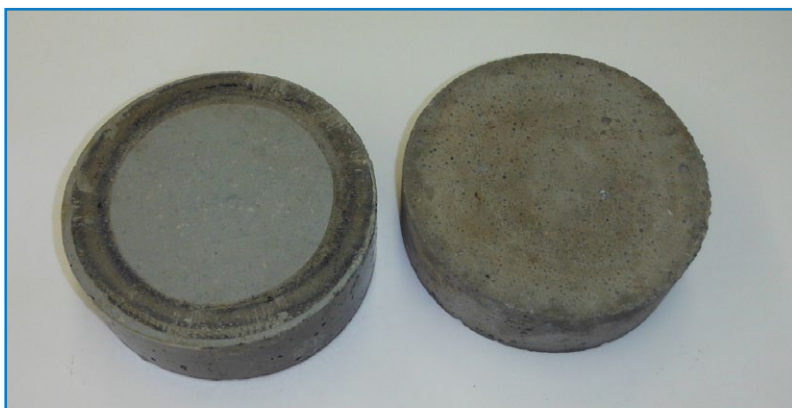
Рис. 2. Внешний вид образцов с системой покрытия и на основе водно-дисперсионной краски COLORITE BETON и контрольных образцов для испытаний на водонепроницаемость.
