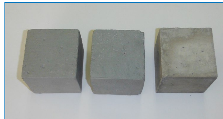
Рис. 4. Внешний вид образцов перед испытаниями на морозостойкость.
