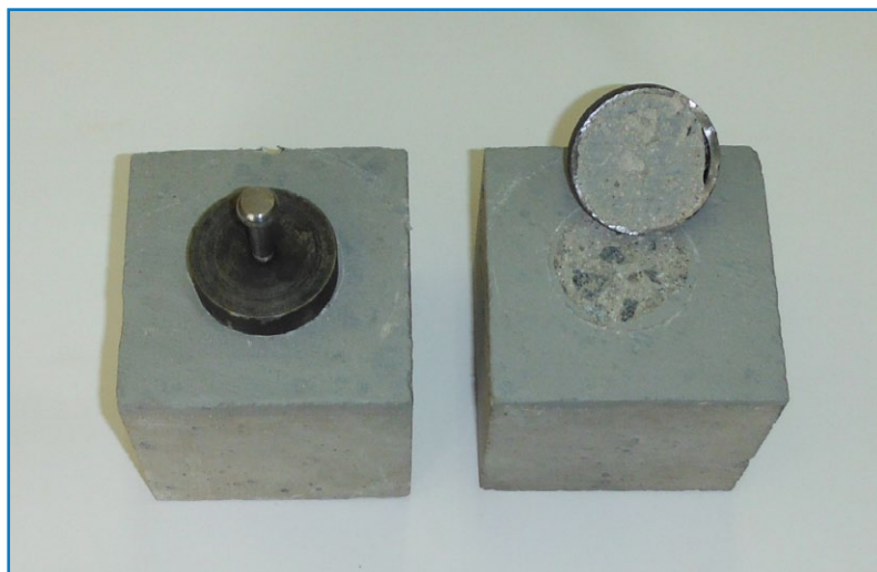
Рис. 10. Внешний вид образцов бетона с системой покрытия на основе водно-дисперсионной краски COLORITE BETON до испытаний и после испытаний на адгезию.
