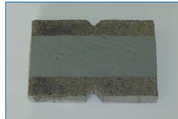
Рис. 7. Внешний вид образца бетона с покрытием до испытаний на трещиностойкость.
