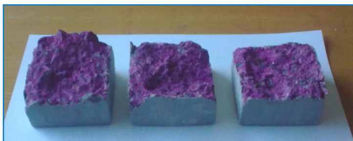
Рис. 13. Внешний вид бетонных образцов с системой покрытия «COLORITE BETON» после 14 суток испытаний
